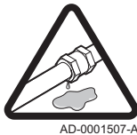
Rys.53 Zwrócić uwagę na wycieki wody
